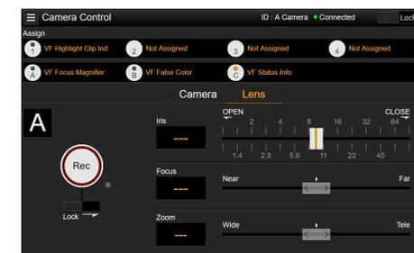
Les contrôles de l'objectif pour le zoom, la mise au point et le diaphragme sont affichés sur l'écran Lens.
